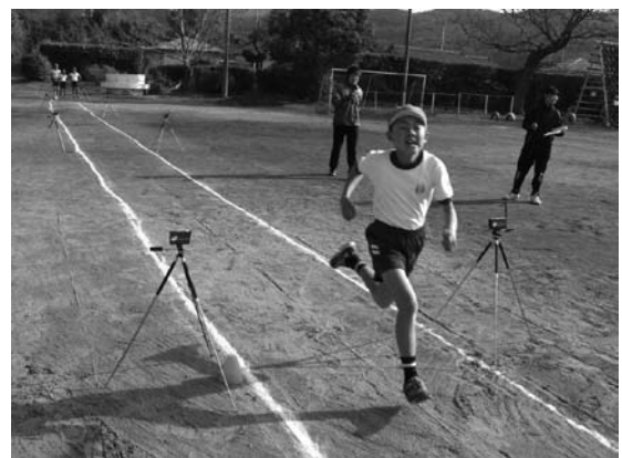
写真2. 光電管計測器を使った50m走の測定
