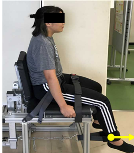
図 2-g. EMGmvc の測定方法（外側広筋および内側広筋）
