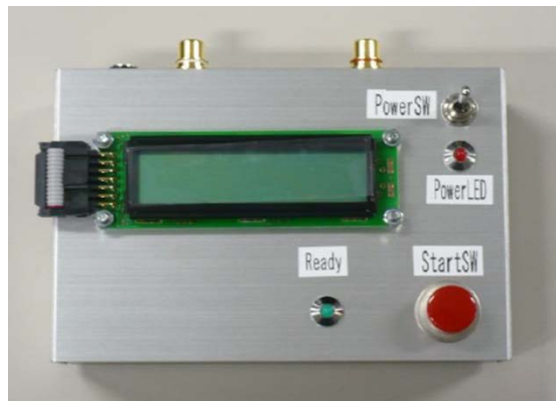
図 2.2 テープスイッチ (A), マットスイッチ(B)および時間差測定装置 (C)
