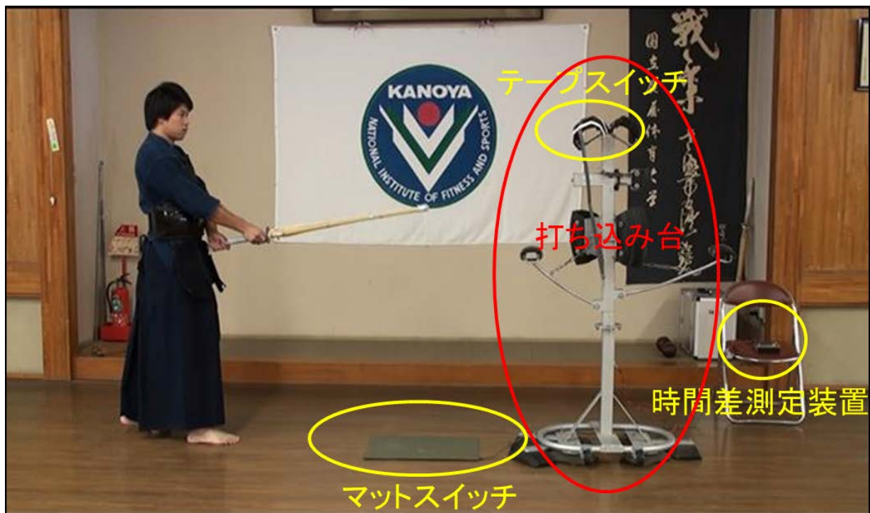
図 4.1 測定機器の設置
