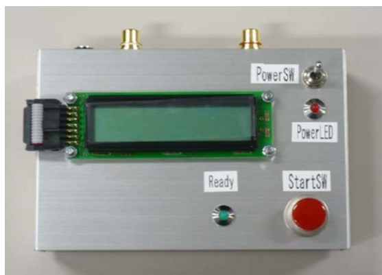
図 3.6 テープスイッチ (A), マットスイッチ(B)および時間差測定装置 (C)
